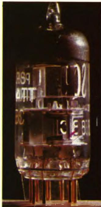
A invenção da válvula triodo (esquerda), permitindo o controle de sinais elétricos, marcou o início da eletrônica. Surgiram outras válvulas, como o tétrodo, de quatro eletrodos, e o pêntodo, de cinco (direita).
