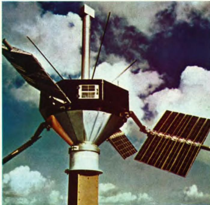
Os braços retráteis de baterias solares, como as do Explorer IV, transformam o calor do Sol na energia elétrica que aciona os instrumentos.
